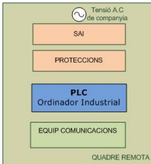
Elements del quadre d'estació remota
